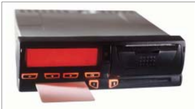
Figura 2 Cronotachigrafo digitala con carta tachigrafa inserita
