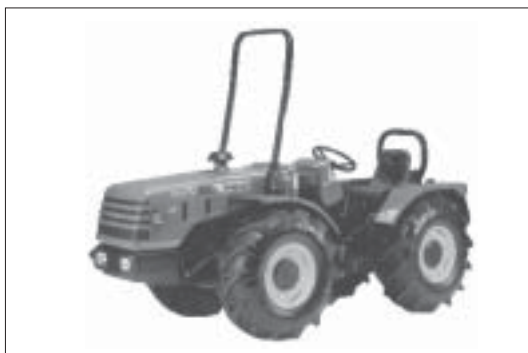
Figura 5 Trattrice dotata di telaio di protezione anteriore a due montanti
