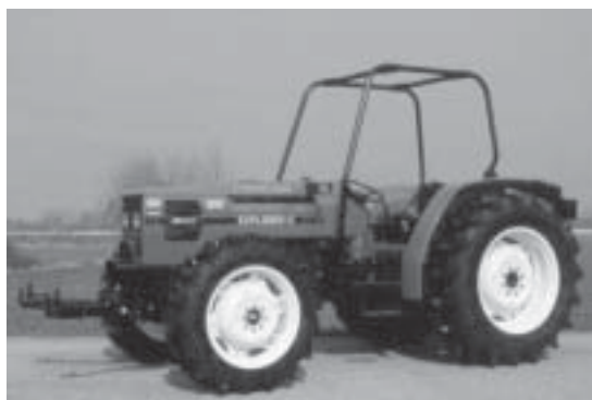
Figura 4 Trattrice dotata di telaio di protezione a 4 montanti
