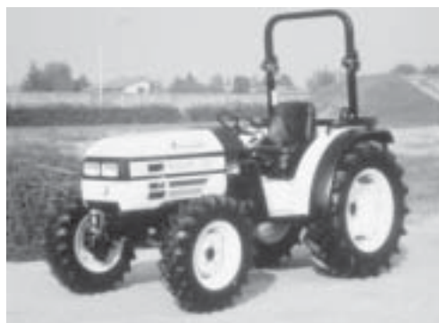
Figura 6 Trattrice dotata di telaio di protezione posteriore a 2 montanti
